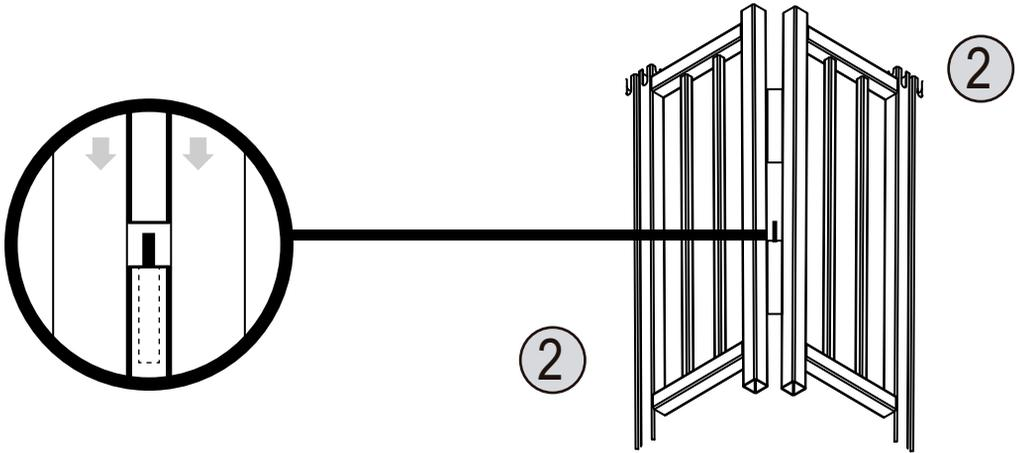
4. Coloque los seguros en cada puerta y asegúrelos con la base en la plataforma.
