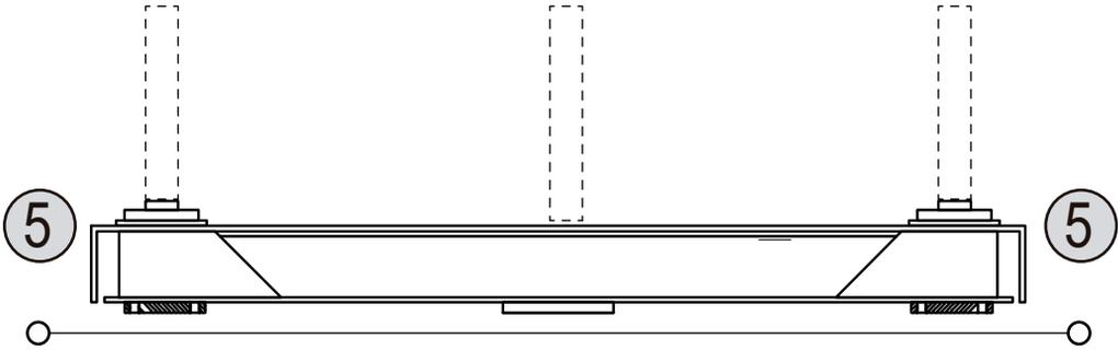
2. Coloca los 2 barandales laterales sobre la base de la plataforma, posteriormente debes colocar los tornillos de cuerda estándar (10 mm) en cada soporte para asegurar los barandales con la plataforma.
