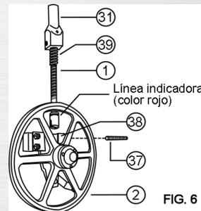
**Nota:** Para alargar la funcionalidad de su equipo y la vida útil de sus piezas mantenga lubricados los siguientes componentes: resorte (39), perno (1).
