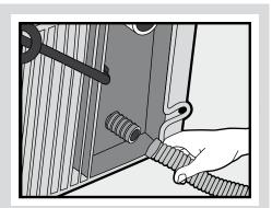
2.- Conecte también la manguera de alimentación a la válvula de entrada del equipo, usando la tuerca plástica para apretarla, y el otro extremo a la toma de agua.
